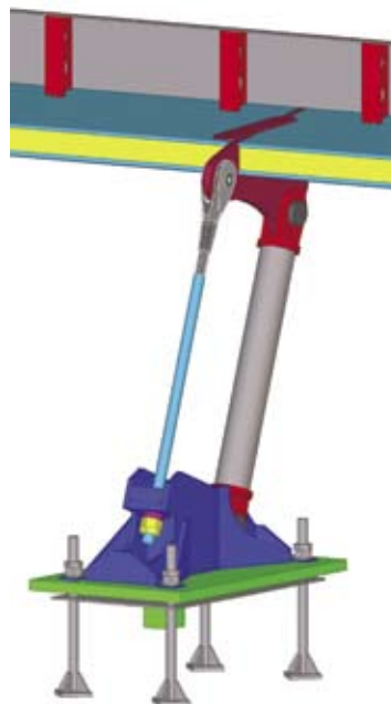
▼ Kývné stojky podporují tuhý obvodový věnec tak, aby nebylo bráněno pohybu konstrukce, vizualizace
